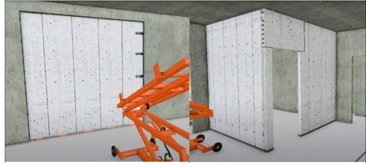
THI CÔNG TẤM TƯỜNG BÊ TÔNG NHE THEO HƯỚNG NẰM NGANG
