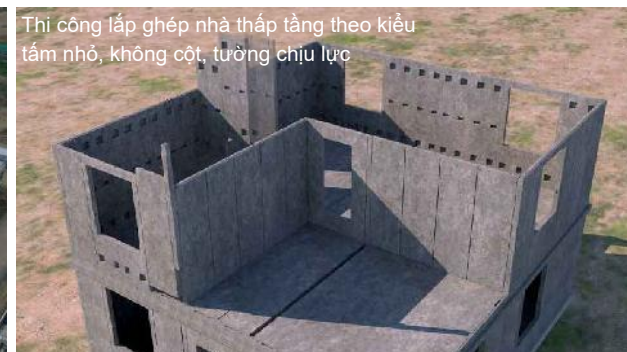
Cấu kiện dạng tấm sàn nhỏ, được thi công lắp đặt tương đối nhanh, vận chuyển dễ dàng
