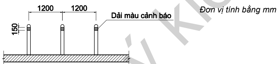
Hình 28 - Khoảng cách an toàn giữa các cọc đứng độc lập
